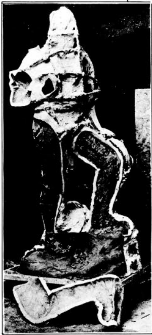
(6) Después de haber colocado el barro se rompe en secciones como se puede ver en la fotografía. La ilustración muestra los sistemas de cubierta usados para reforzar el molde, al igual que el procedimiento de romper las secciones después de insertar las láminas de bronce. Este molde se vuelve a armar, recíndose un nuevo moldeado de barro, que va a la fundición para ser vaciado en bronce.
